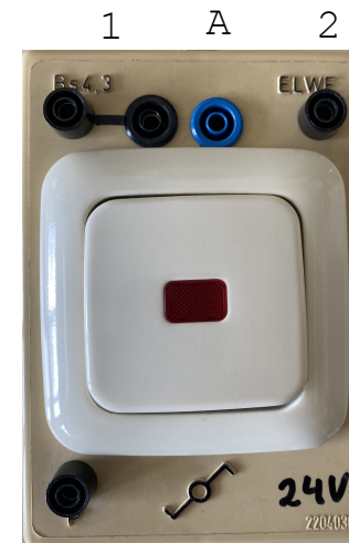
Wechselschalter mit Kontrollleuchte (Betriebszustandsanzeige)
